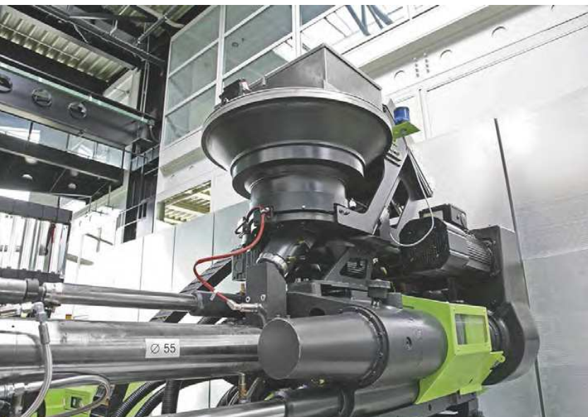
Insieme al partner Engel, l'R&D Center di Mesgo sta sviluppando un processo per la miscelazione in situ dei due componenti silicnici allo stato solido. I test sono effettuati su una pressa flexseal 300 T dotata di roto feeder
