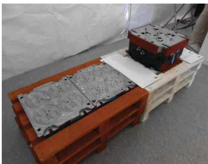
In alto, il Canale Freddo Otturatore (CFO) a otto ugelli di OR.P. Stampi. A sinistra, stampo O-ring a 4 cavità large (145 x 2,5) e 12 small (42,65 x 3,4) e, a lato, il Canale Freddo Ugelli Mobili (CFM) di OR.P. Stampi. Sopra, O-ring derivanti da stampate con Canale Freddo Ugelli Mobili (CFM) di OR.P. Stampi.
