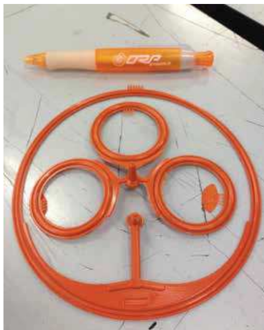
In alto, il Canale Freddo Otturatore (CFO) a otto ugelli di OR.P. Stampi. A sinistra, stampo O-ring a 4 cavità large (145 x 2,5) e 12 small (42,65 x 3,4) e, a lato, il Canale Freddo Ugelli Mobili (CFM) di OR.P. Stampi. Sopra, O-ring derivanti da stampate con Canale Freddo Ugelli Mobili (CFM) di OR.P. Stampi.
